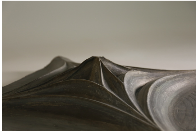
Précision millimétrique d'un béton coulé dans un coffrage imprimé en 3D (photo Lian Stähelin)
