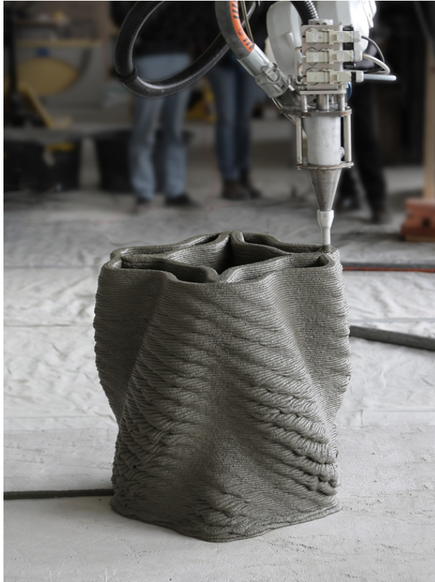
L'impression 3D pour explorer les limites du matériau (photo Keerthana Udaykumar)
